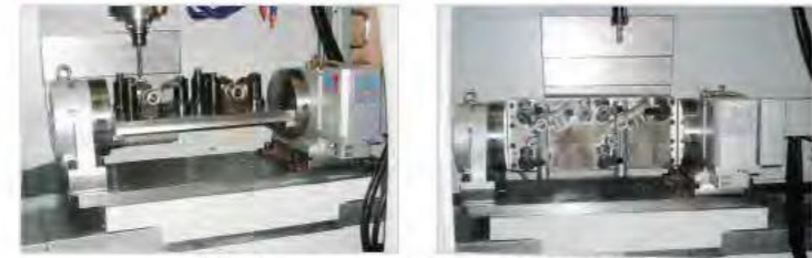
Пример установки заготовки
